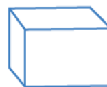
Hình 2.42. Hình chiếu trục đo xiên góc cân của hình hộp chữ nhật
