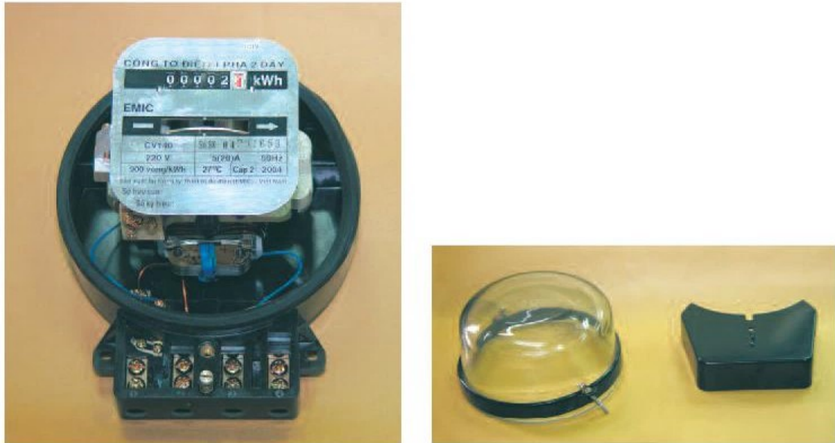
Hình 4 - 1. Công tơ điện.
