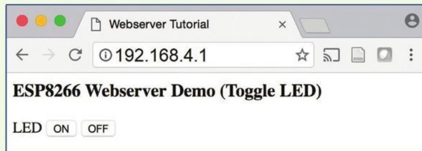
Hình 7. Giao diện ứng dụng kết nối với robot thông qua Wi-Fi
