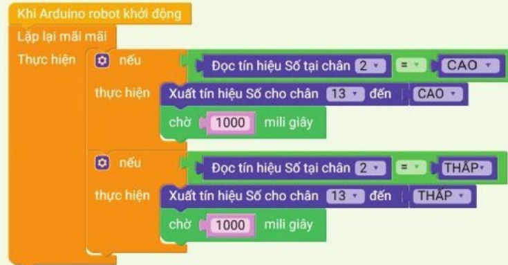
Hình 8. Minh họa cấu trúc lập trình tuần tự, rẽ nhánh và lặp trong EasyCode
