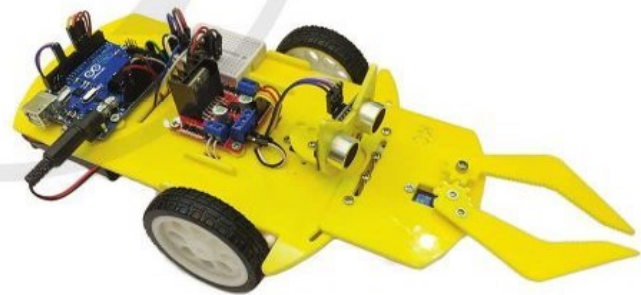
Hình 12. Robot Arduino hoàn chỉnh sau lắp ráp
