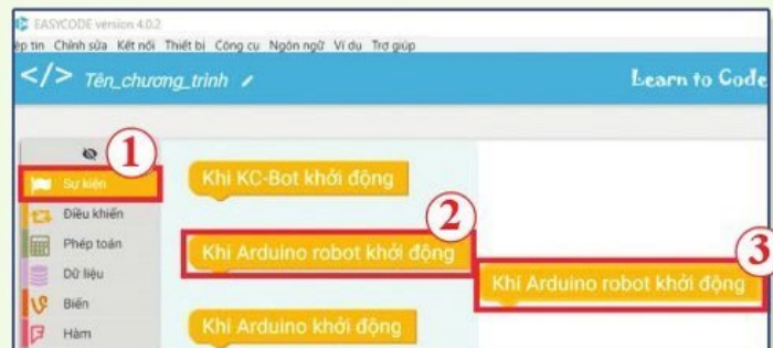
Hình 4. Chọn và kéo khối lệnh ra khu vực lập trình
