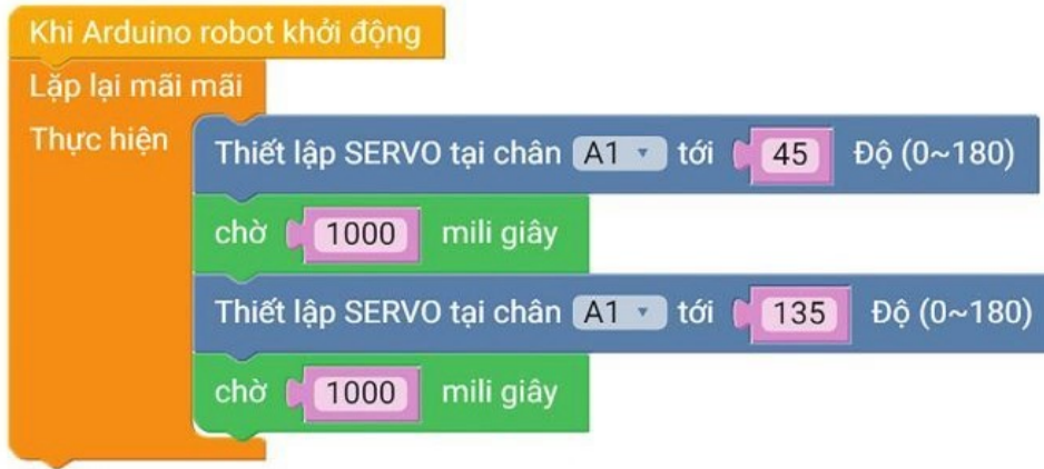
Hình 2. Chương trình điều khiển tay gấp robot hoạt động gấp và nhả liên tục
