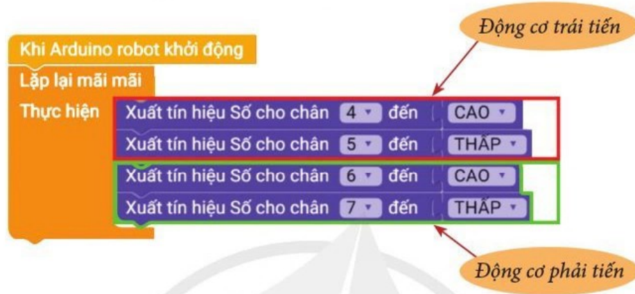
Hình 2. Chương trình điều khiển robot di chuyển tiến
