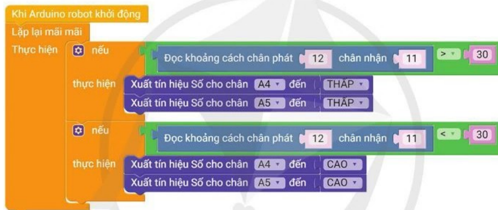
Hình 6. Chương trình mẫu Cảnh báo va chạm bằng cảm biến siêu âm
