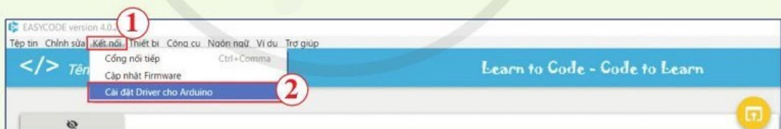
Hình 7. Cài đặt driver để kết nối robot với máy tính
