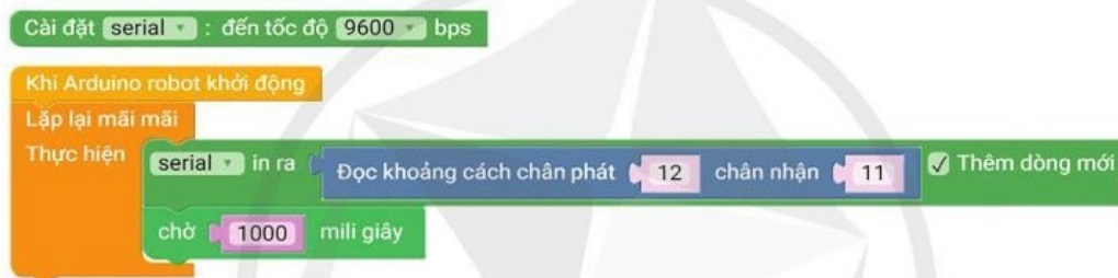
Hình 4. Chương trình mẫu đọc khoảng cách bằng cảm biến siêu âm
