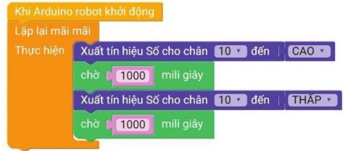
Hình 2. Chương trình mẫu điều khiển đèn LED
