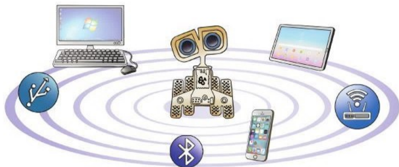
Hình 1. Các kênh truyền thông giữa robot và máy tính
